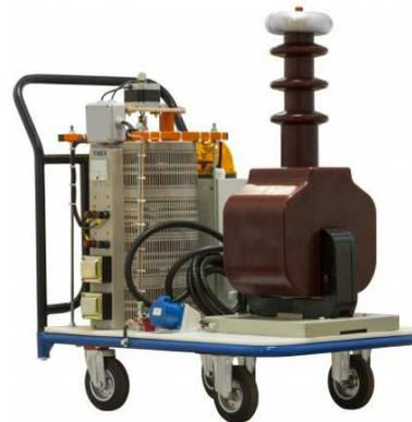
Отличительной особенностью модификации **аппарата испытания диэлектриков АИСТ 100/20М с "сухим" трансформатором** является использование испытательного трансформатора сухого типа. Это компактная, легкая эргономичная конструкция, имеет высокие влагостойкие показатели, не требует обслуживания в течение всего срока службы.
