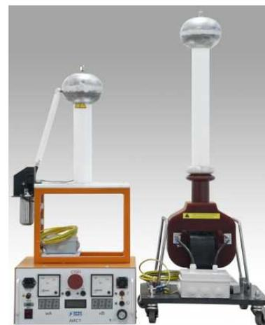
Отличительной особенностью модификации **аппарата испытания диэлектриков АИСТ 50/70М с "сухим" трансформатором** является использование испытательного трансформатора сухого типа. Это компактная, легкая эргономичная конструкция, имеет высокие влагостойкие показатели, не требует обслуживания в течение всего срока службы.
