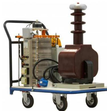
Отличительной особенностью модификации **аппарата испытания диэлектриков АИСТ 100М с "сухим" трансформатором** является использование испытательного трансформатора сухого типа. Это компактная, легкая эргономичная конструкция, имеет высокие влагостойкие показатели, не требует обслуживания в течение всего срока службы.
